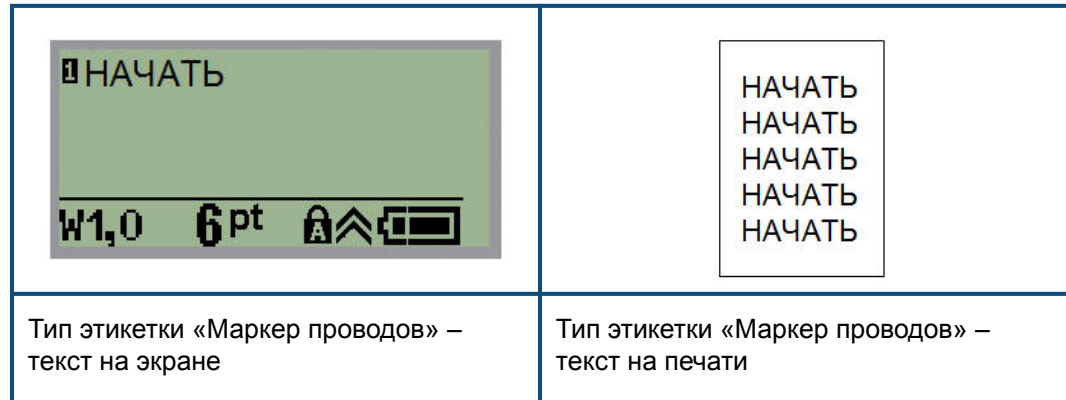
Рис. 6 • Повторяющиеся данные на этикетках типа «Маркер проводов»
